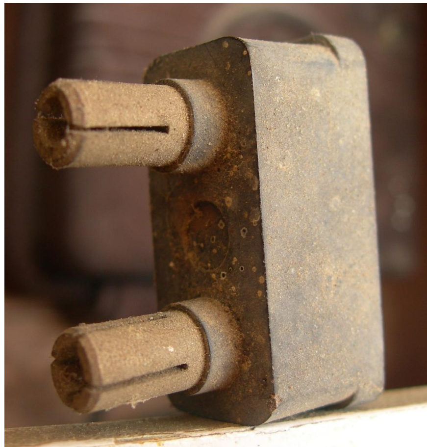
Fusível para quadro elétrico antigo
